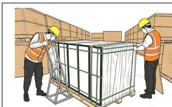
Coloque el accesorio anti-vuelco en un lado de la caja, retire las correas de sujeción del módulo
